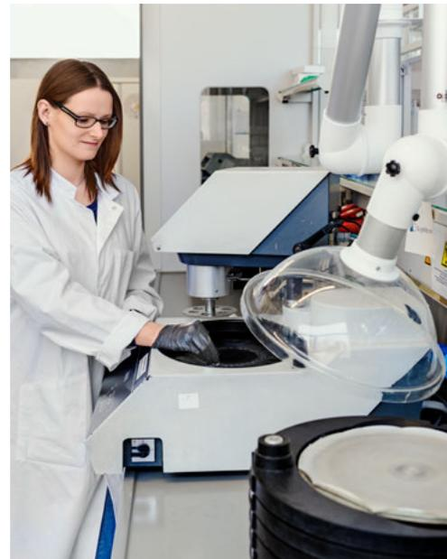
Bevor das Gefüge analysiert werden kann, ist zunächst eine ausgezeichnete Schlißpräparation notwendig
