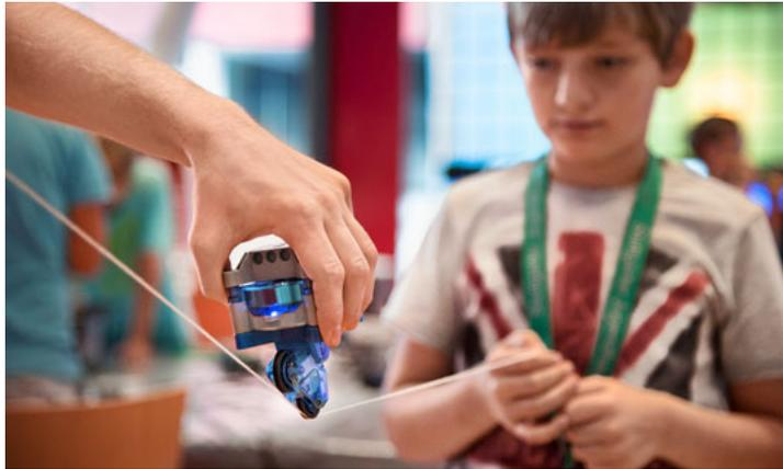
**Gyroskop-Roboter:** Durch die Hilfe eines drehenden Kreisels im Inneren kann der kleine Roboter über ein Seil balancieren. Diese Technik wird beispielsweise auch in Satelliten verwendet.
