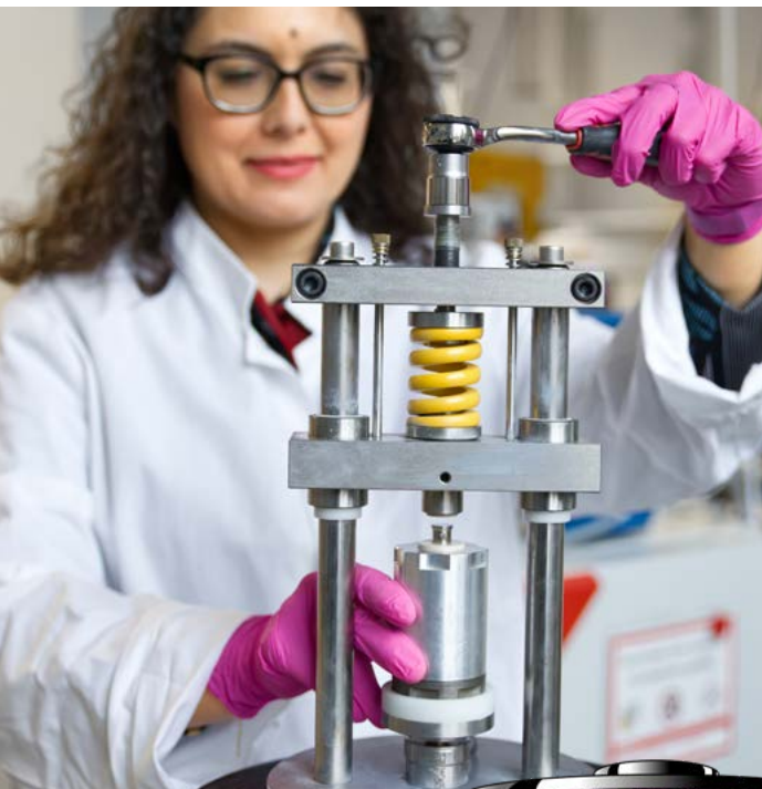
Bild oben: Dr. Pinar Kaya am Batterieprüfstand mit einer Testzelle Bild rechts: Architektur einer modernen Festkörperbatterie
