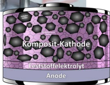
Bild oben: Dr. Pinar Kaya am Batterieprüfstand mit einer Testzelle Bild rechts: Architektur einer modernen Festkörperbatterie
